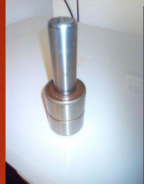
Ca commence fin août avec le ventilateur qui est une première fois démonté. La soudure effectuée casse. Il faut refaire l'axe et la couronne et remonter l'ensemble sur le ventilateur.
