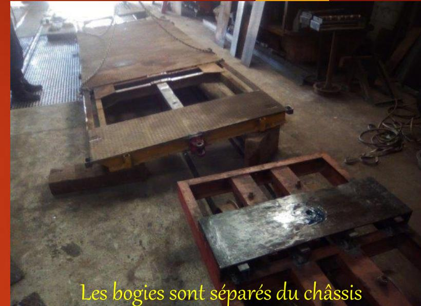
*Les bogies sont séparés du châssis*
